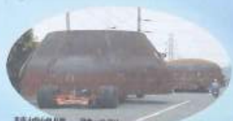
轉爐爐體一體成型 厚70mm×直徑約8,000mm
